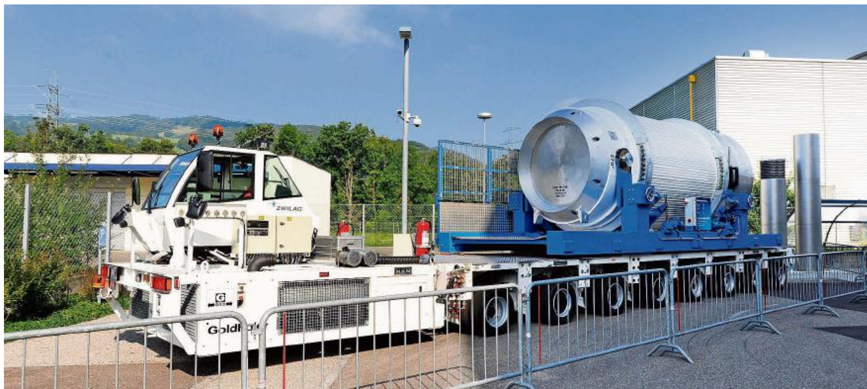
Die schweren Behälter mit hoch radioaktiven Abfällen werden per Spezialfahrzeug ins Zwischenlager Würenlingen geliefert.
